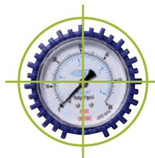
Equipado com manômetro classe B que corresponde ao erro máximo de 2% do fundo de escala para as leituras entre 25% e 75% da pressão máxima e 3% para as demais leituras.
